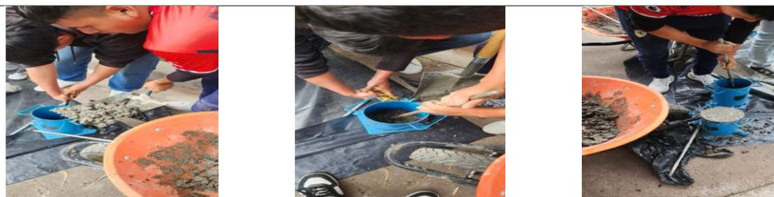
*Nota:* Colocación del hormigón en los cilindros.
