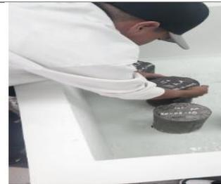
*Nota:* Desencofrado del hormigón y colocación en la piscina de curado.
