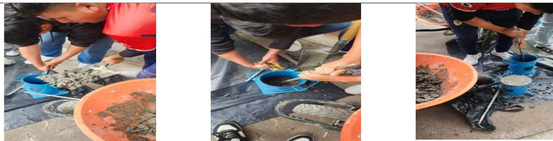
*Nota:* Colocación del hormigón en los cilindros.
