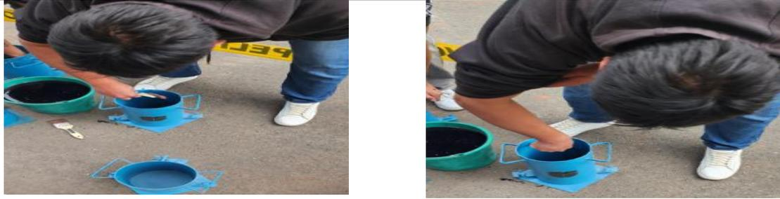
*Nota:* Aplicación de aceite en los moldes para desencofrar fácil.
