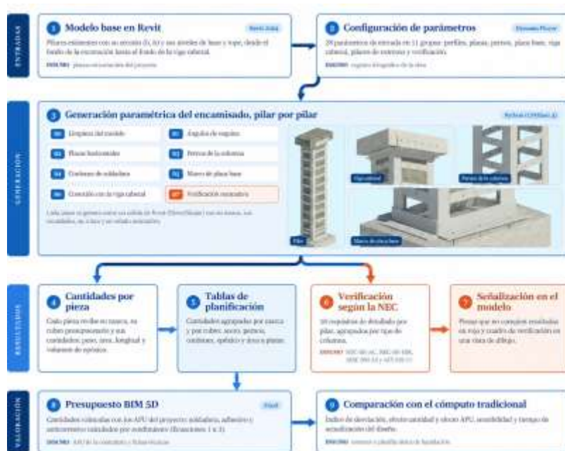
Figura 2 Flujo de trabajo BIM 5D para la cuantificación, el presupuesto y la verificación normativa del encamisado metálico
